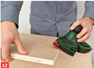
12 Die Kanten der Tischplattenteile brechen und die Flächen für die Oberflächenbehandlung schleifen (siehe Praxistipp)
