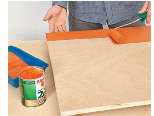
Die Tischplatten streichen wir in Terracotta. Hier eignet sich ein Farbröller
