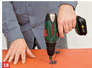
18 Jetzt können Sie die beiden ausklappbaren Tischplatten mit Scharnieren an der Haupttischplatte befestigen
