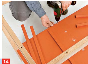
14 Zwei seitliche Leisten und eine Querleiste bilden den Rahmen, die restlichen Leisten die Fächer. Löcher unbedingt vorbohren!
