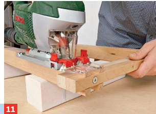
11 Damit die Klappbeine am Mittelteil angebracht werden können, müssen Sie die Überstände abschneiden
