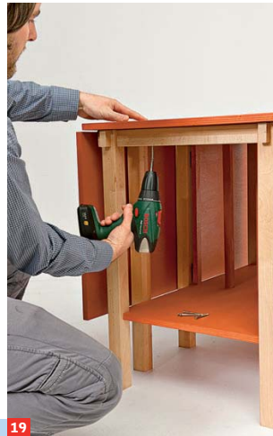
19 Schrauben Sie anschließend die mittlere Tischplatte von unten an die Unterkonstruktion
