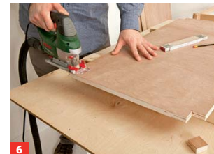
6 ... Leisten für die Stuhlfächer zu. Für die Ausklinkungen der Beine beim Einlegeboden verwenden Sie eine Stichsäge
