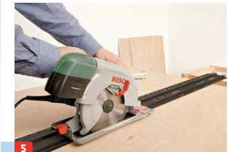
5 ... Schnitte eine Handkreissäge mit Führungsschiene verwenden. Schneiden Sie auch die drei Tischplatten und die ...
