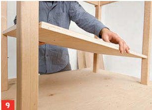
9 Ob Sie beim Einlegeboden exakt gearbeitet haben, sollten Sie jetzt einmal ausprobieren
