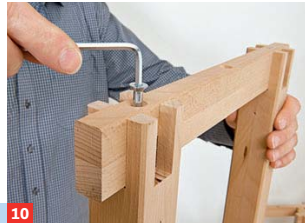
10 Die Seitenteile bestehen je aus einer 350 mm langen Zarge und zwei Beinen. Verbinden Sie alles mit Inbusschrauben
