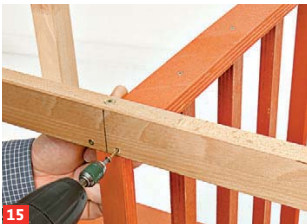
15 Querleiste seitlich mit den Zargen verschrauben. Senkrechte Hölzer jeweils unten mit Einlegeboden und Querleiste ...
